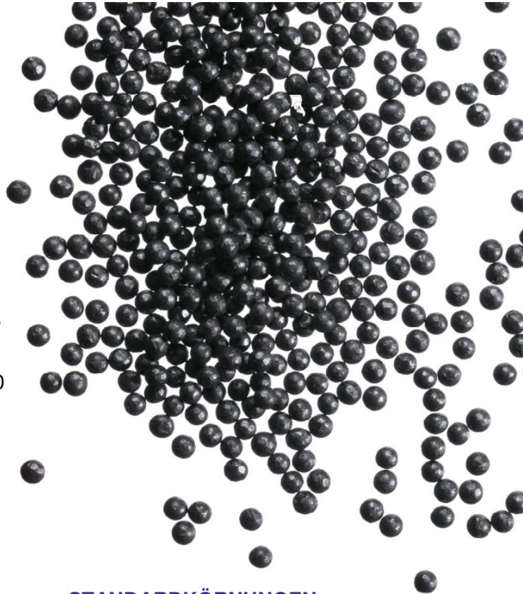
**Steel Shot** ist ein gegossenes, rundes, metallisches Strahlmittel nach ISO 11124-3 M/HCS/S und anwendbar gemäß den Anforderungen der BGR 500 Teil 2, Kapitel 2.24, Arbeiten mit Strahlgeräten (Strahlarbeiten) mit folgenden technischen Daten:
