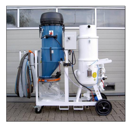
Druckstrahlanlage mit Rücksaugung und Strahlmittelaufbereitung
